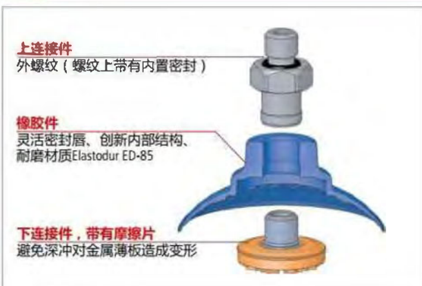
真空吸盘TAPG 结构设计
