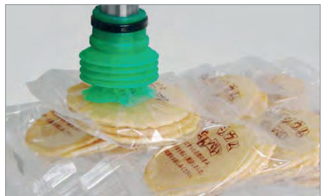
波纹吸盘SPB4用于搬运薄膜包装的米饼
